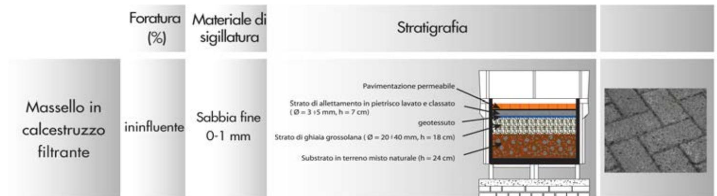
Figura 1 - Fonte: Linee Guida per la determinazione della capacità drenante delle pavimentazioni modulari in calcestruzzo di Assobeton
