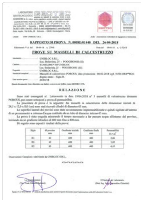
Rapporto di prova della capacità drenante dei masselli di calcestruzzo "Porous"
