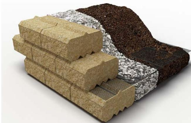
Schema di abbinamento del blocco EMC 25 con geogriglia per paramento verticale
