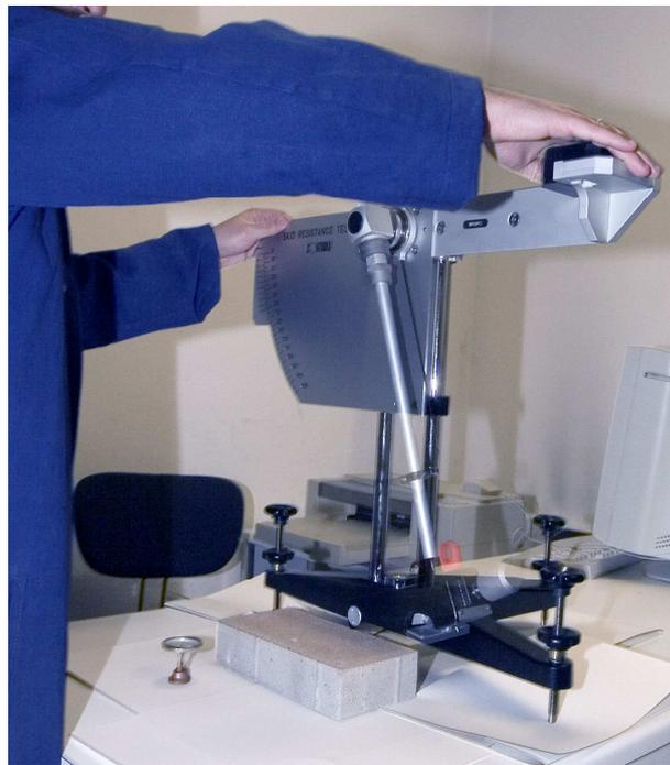
Esecuzione del test di resistenza allo scivolamento presso il laboratorio UNIBLOC
